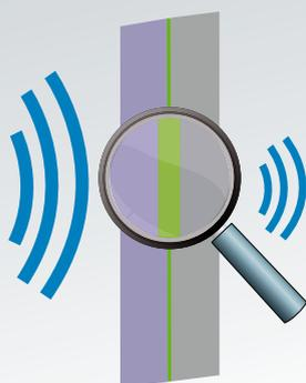
Rigips® Duo'Tech è composto da due lastre speciali di 12.5 mm di spessore, unite con una colla high-performance che conferisce loro delle caratteristiche fonoisolanti eccellenti.
